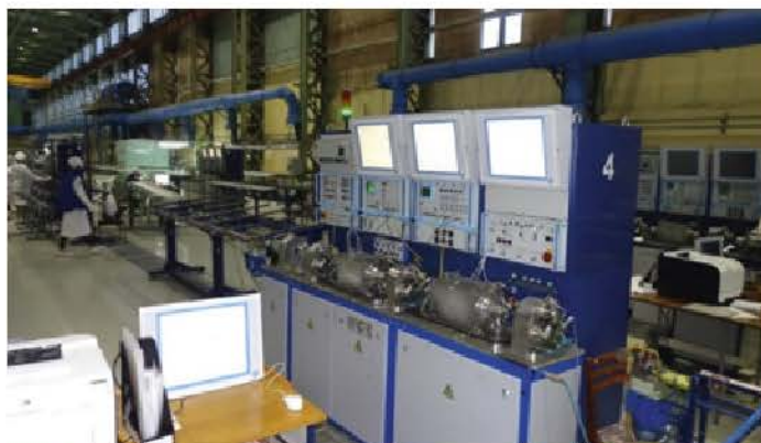
7. Осуществлена поставка блока акустического контроля сплошности ДУ-193-М для установки неразрушающего контроля трубной и прутковой продукции.
