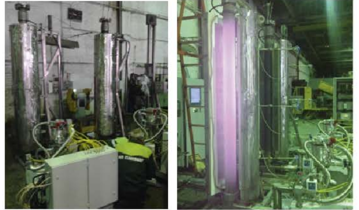
3. Оборудование, изготовленное для производства ТВЭЛов для атомных реакторов ледокольного флота и атомных подводных лодок М4735 Установка осушки и опрессовки изделий.
